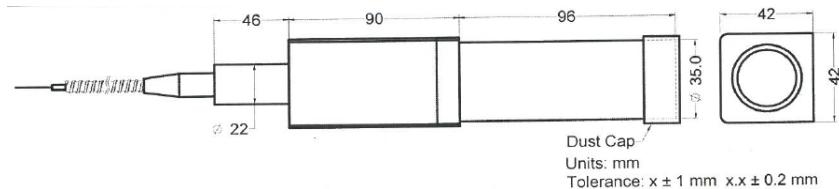
激光器外观尺寸如下图所示（单位：mm）。
