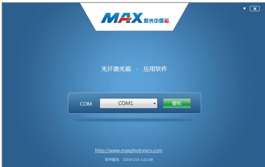
(5) 使用随机自带的串口连接线连接激光器和 PC 机，选择端口号，点击连接激光器，进入如下监控界面。
