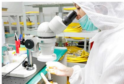
显微镜上安装光纤连接器
