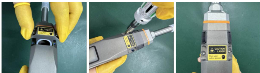
图 7：将聚焦镜按上图方向装入，再锁紧左右两边两颗螺丝
