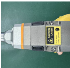
⑥ 将保护镜座装入腔体
