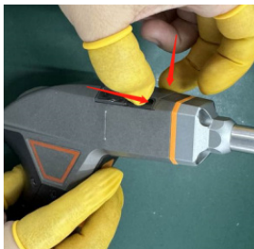
① 拇指和中指扣住保护 镜座两侧弹片
