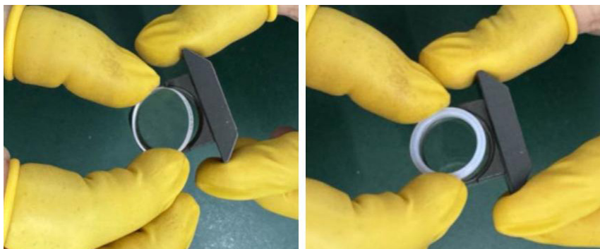
图 6：清洁干净后，聚焦镜凸面朝下装入，再将泛塞封装入
