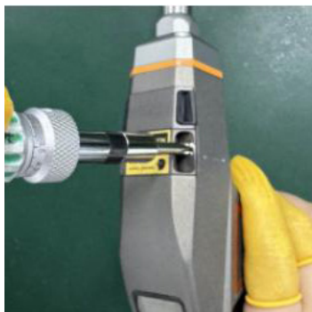
图 1：用螺丝刀拆解聚焦镜座螺丝
