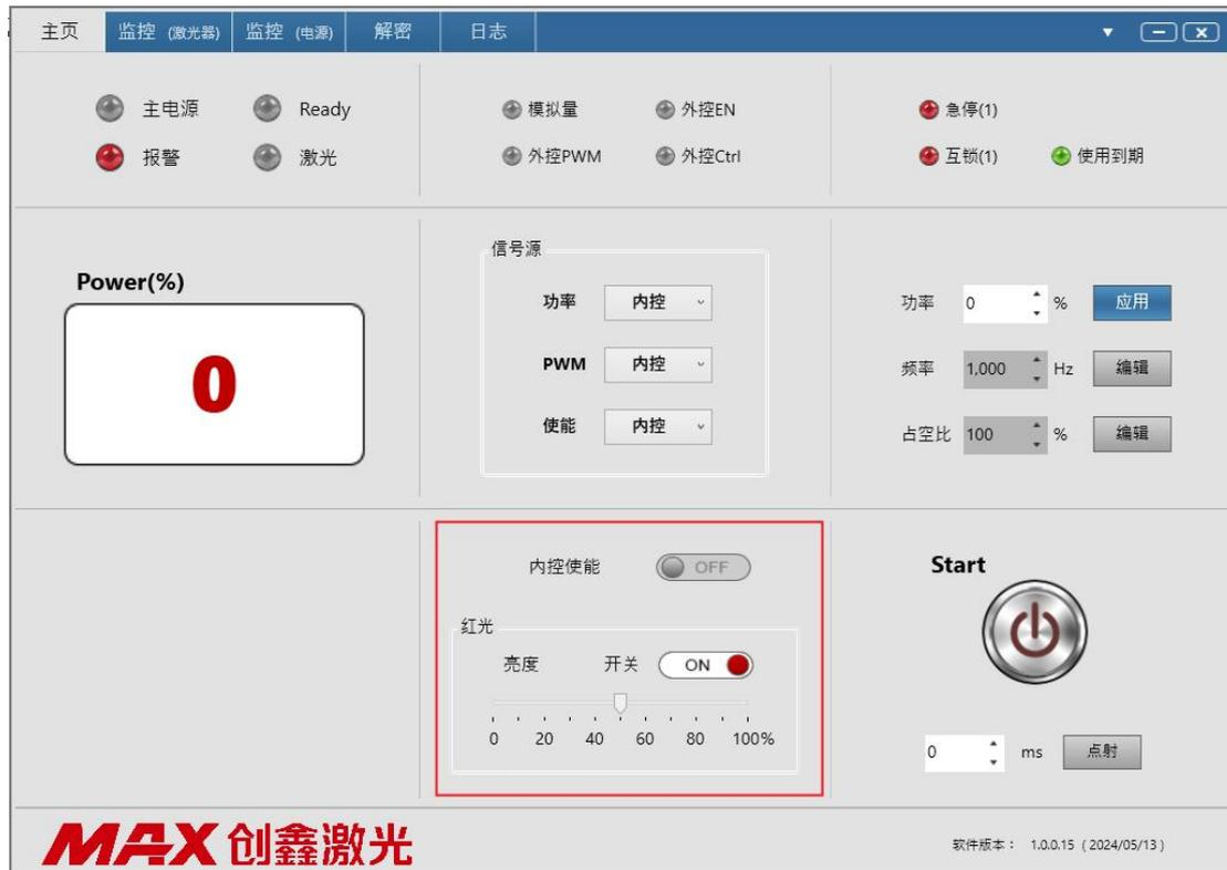
注意，红光要在“用户内控”的模式下才能手动控制开关，模式已在出厂时配置好。
