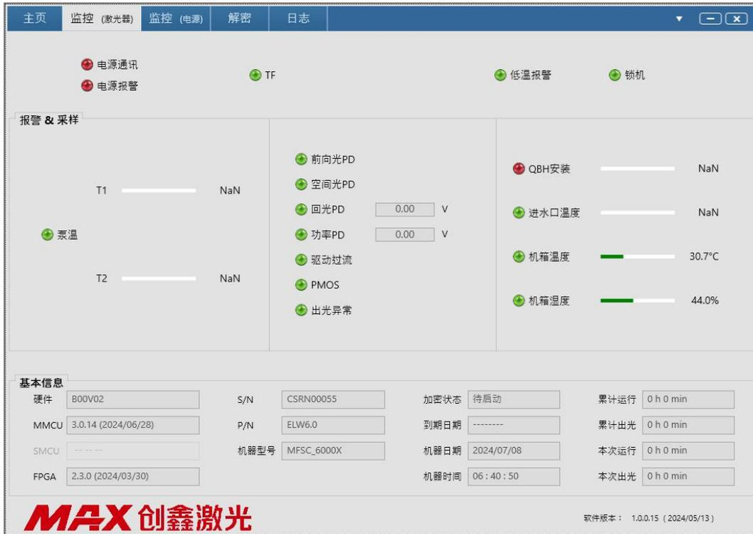
❖ 状态栏：最上面一栏，展示的是电源整体的通讯和报警情况（具体的需要转至电源监控页面）、是否检测到 TF 卡、是否触发低温报警、是否触发锁机报警（包含连续 QBH 报警锁机、连续前向光报警锁机、连续回光报警锁机、连续 PMOS 报警锁机、连续解密错误锁机，触发报警后会变红并显示报警种类）。
