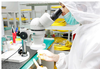
显微镜上安装光纤连接器
